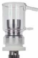
Использование ячейки позволяет провести обработку образца без применения зонда, тем самым, исключая любую возможность перекрестной контаминации или загрязнения из воздуха. Имеет особое значение при работе с инфекционными материалами. Области применения: «мягкое» разрушение клеток, освобождение клеточного материала из вирусов и др.
