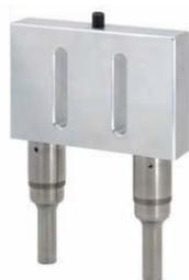
Двойные зонды предназначены для одновременной обработки ультразвуком двух образцов объемом 25-500 мл. Набор состоит из алюминиевой соединительной муфты (кат. № 630-0562) и двух сплошных зондов с диаметром наконечника 19 мм (кат. № 630-0208). Мощность каждого зонда одинакова и составляет по ½ от общей подающейся мощности. Расстояние между центрами двух зондов составляет 144 мм.
