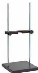
**Кат. № 830-00320** – штатив для конвертера и мультиэлементного зонда. Размеры основания: 254 x 254 мм, высота: 622 мм.
